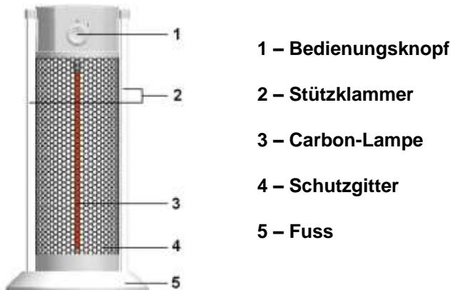
Der Under table heater ist mit einer **Umfallsicherung** versehen, die ihn ausschaltet, wenn er unerwartet umfallen sollte. Wenn Sie ihn danach wieder gerade aufstellen, nimmt er seinen Betrieb wieder auf, aber schalten Sie ihn zunächst aus, entfernen Sie den Stecker aus der Steckdose und kontrollieren Sie den Heater auf Beschädigungen. Bei Beschädigung oder abweichender Funktionstüchtigkeit nicht benutzen, sondern zur Kontrolle/Reparatur geben.
